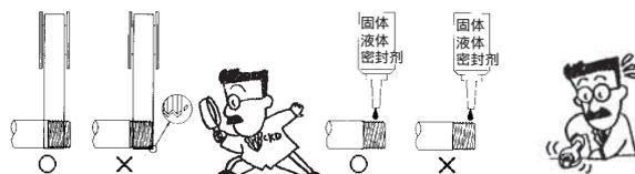
拧入类型接头请使用密封带或密封剂,不要过度拧入。紧固时请用扳手夹在金属部分进行操作。
